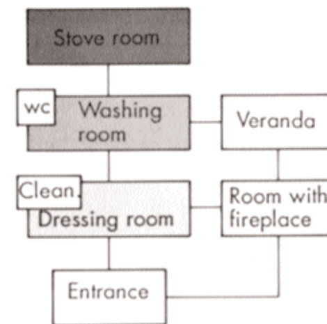
Рис.37. Соединения между помещениями домашней сауны
