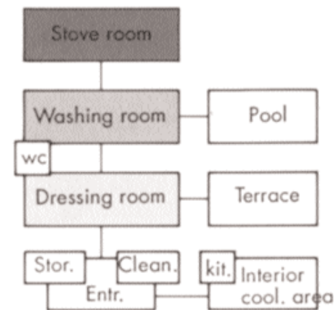
Рис.48. Соединения между частями сауны для гостей.
