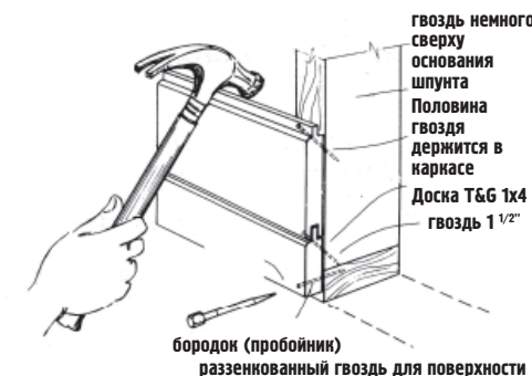
Рис. Забивание гвоздей «вслепую» (гвозди с утопленной шляпкой) и зенковка (врезание заподлицо)
