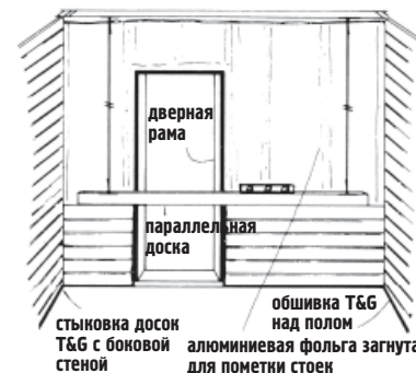
Рис. Установка обшивки T&G для передней (фронтальной) стены
