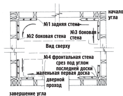
Рис. Вертикальная обшивка T&G – последовательность для стен
