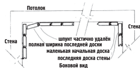
Рис. Горизонтальная обшивка T&G – последовательность для потолка
