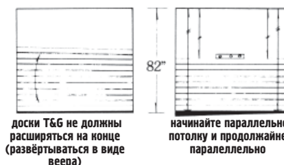
Рис. Прибивание горизонтальных досок T&G
