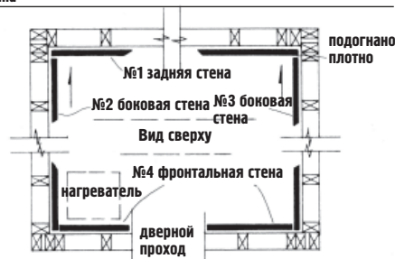
Рис. Горизонтальная обшивка T&G – последовательность для стен
